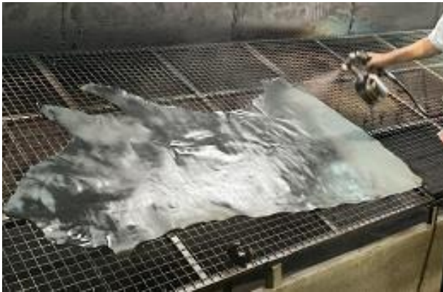
図3 (株)山陽におけるスプレー水性仕上げ
