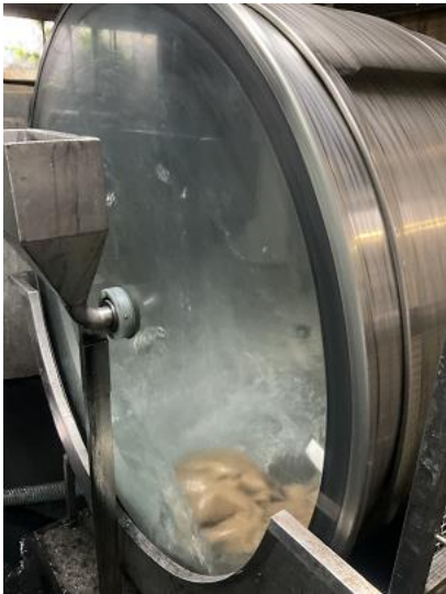
図5 (株)オールマイティが所有するステンレスドラム 図6 仕上げの乾燥工程
