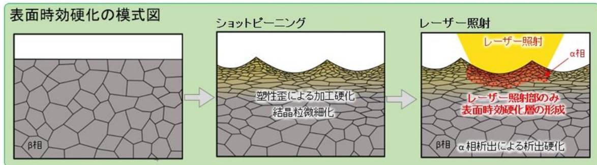
図1 表面時効処理の模式図
