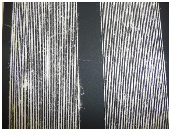
図3 試作紡績糸への水溶性 PVA 繊維の加工による外観 (左：未加工、右：加工後)
