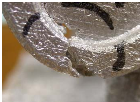
図7 灰化R Pモデル残存により発生した鋳造欠陥部
