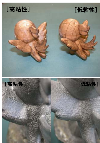
図4 シアノアクリレート系接着剤の粘性による紙積層R Pモデルおよび铸造品への影響
