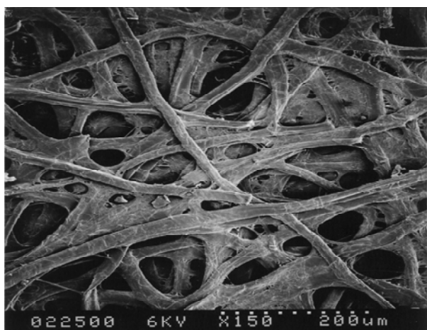
図1 コラーゲン膜のSEM像 ( \text{CaCl}_2 溶液浸漬処理なし、1.0 SBF、pH 7.25、7日)
