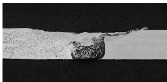
図2 横断面のマクロ組織写真 (左側 : AZ31、右側 : A5052)
