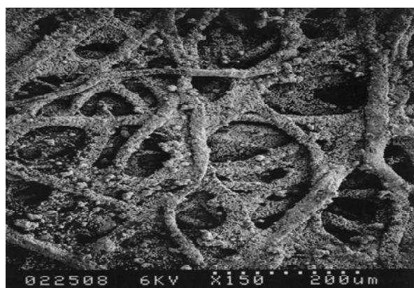
図4 セリシン被覆コラーゲン膜のSEM像 ( 1 \text{ kmol/m}^3 浸漬処理、1.5 SBF、pH 7.25、7日)
