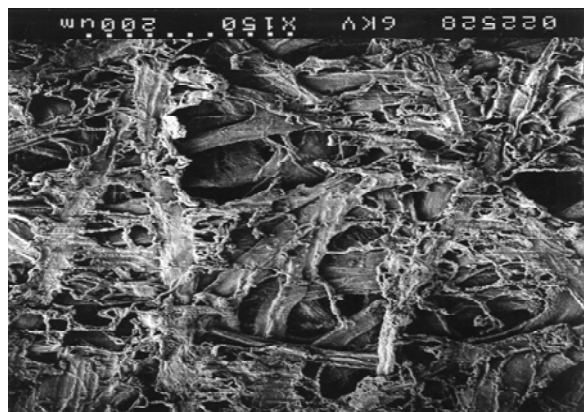
図3 コラーゲン膜のSEM像 ( 1 \text{ kmol/m}^3 浸漬処理、1.5 SBF、pH 7.25、7日)
