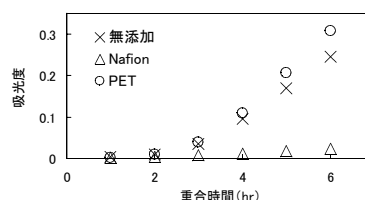
図3 700nmにおける反応液の吸収スペクトル変化
