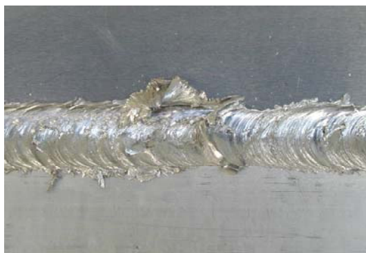
図1 摩擦攪拌接合部の表面写真 (上側 : AZ31、下側 : A5052)
